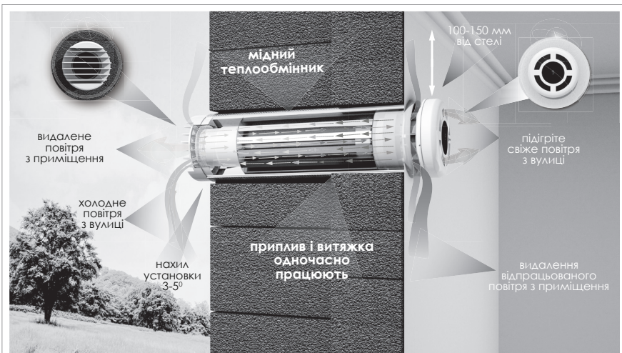
Рис.1. Принцип роботи рекуператора PRANA-150, PRANA-200C, PRANA-200G
